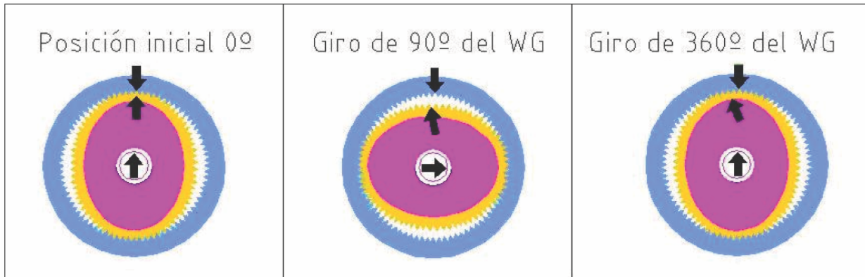
Fig. 2. Mecanismo de operación de un Harmonic Drive .
